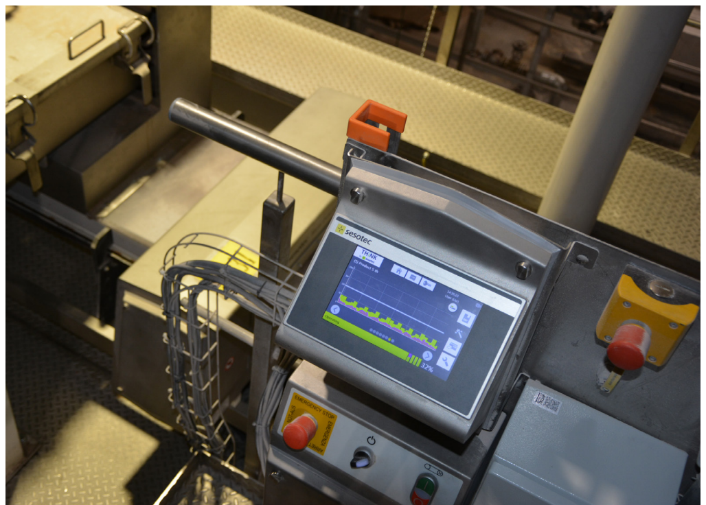
Der Tunnelmetalldetektor INTUITY wird in Förderbänder eingebaut und ist mit THiNK Software ausgestattet.
