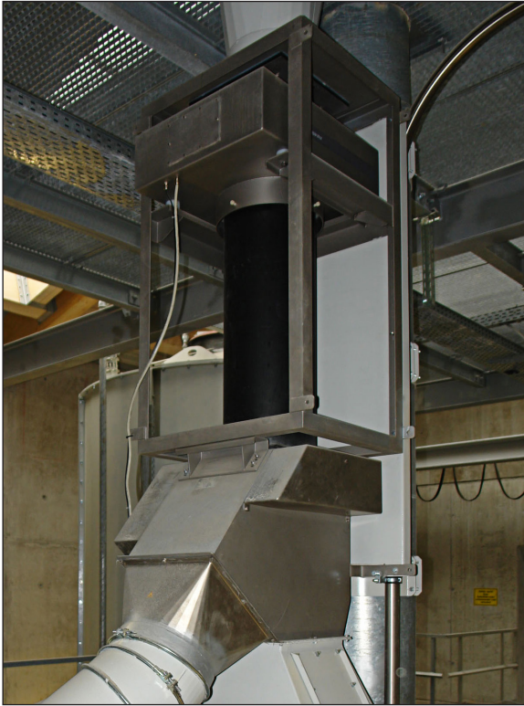
Einbaubeispiel: Metall-Separator RAPID DUAL eingesetzt zum Maschinenschutz bei der Herstellung von Holzpellets. (alte Ausführung)
