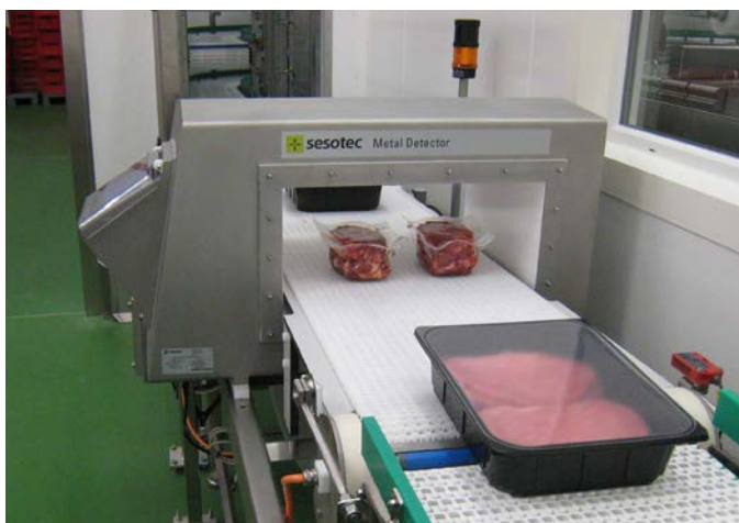
Der Metalldetektor INTUITY mit Multi-Simultan-Frequenz Technologie bei der Untersuchung von sehr unterschiedlichen Produkten.
